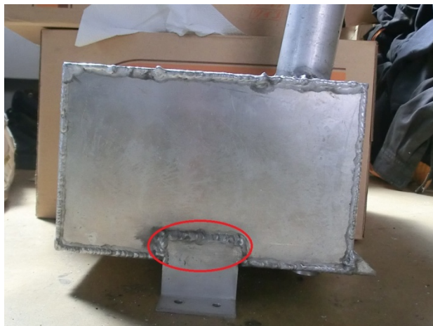
図 燃料タンクの底面と側面 赤色の箇所から燃料漏れが発生
