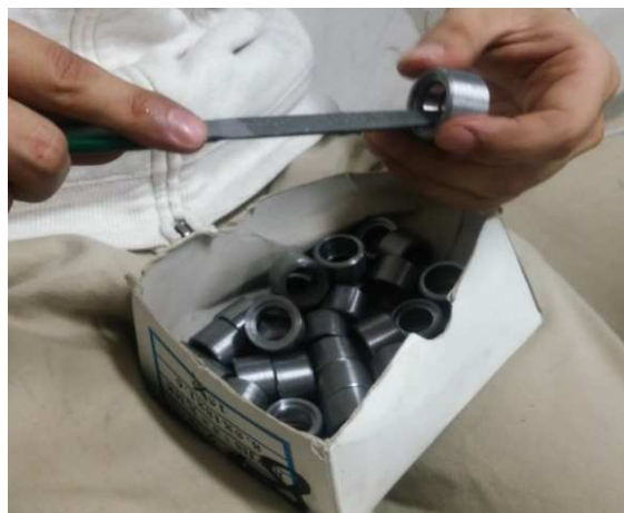
製作中のベアリングケース
